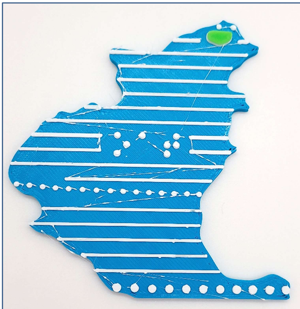
Fot. 3. Widoczne na powierzchni wydruku nieregularne niteczki - błąd retrakcji filamentu.
