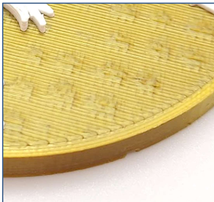
Fot. 6. Wybrzuszenia w postaci charakterystycznych „bąbli” na powierzchni wydruku.
