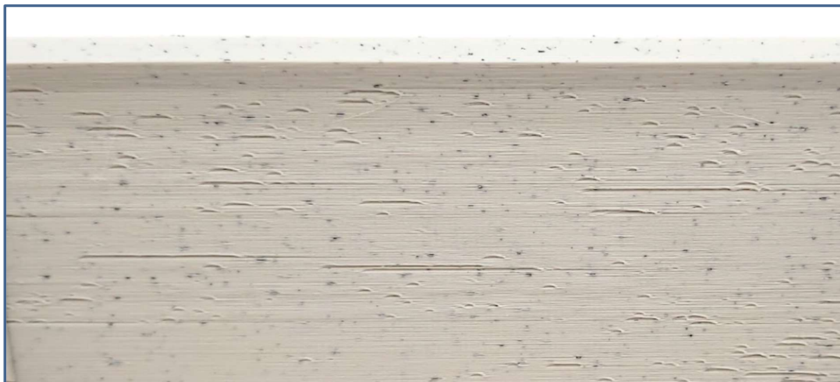
Fot. 2. Szczeliny w ścianie wydruku.
