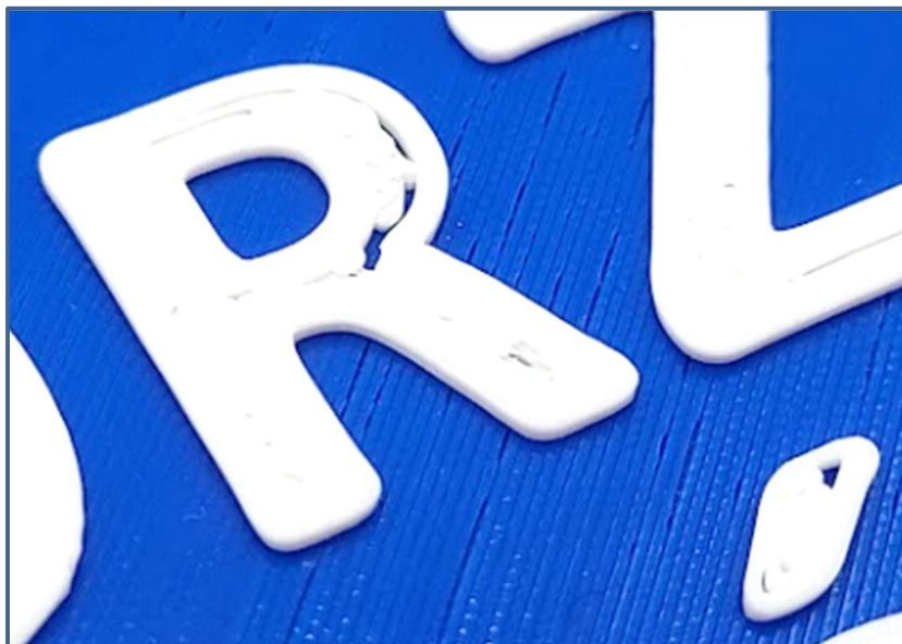
Fot. 7. Nieprecyzyjny zadruk górnych powierzchni modelu.
