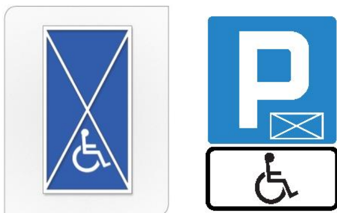
Rysunek 2. Znaki poziome i pionowe stosowane do oznaczania miejsc parkingowych dla osób z niepełnosprawnościami.
