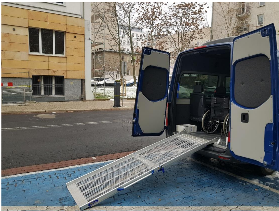
Zdjęcie 4. Wyposażenie pojazdu do przewozu osób z niepełnosprawnościami w rampę najazdową.
