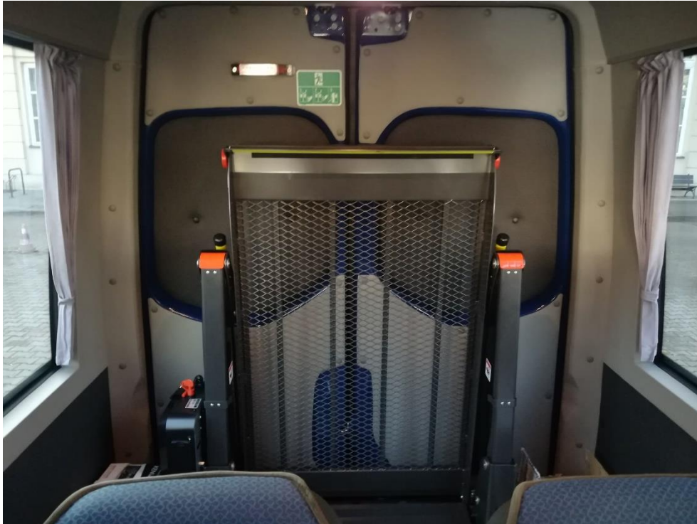
Zdjęcie 5. Wyposażenie pojazdu do przewozu osób z niepełnosprawnościami w windę elektryczną (widok z wnętrza pojazdu przy złożonym podnośniku).
